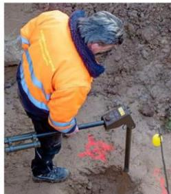
Eine Magnetsonde zeigt an: Im Untergrund liegt Metallisches.
